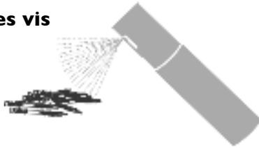
Pour avoir un processus de vissage plus aisé, il est recommandé de lubrifier les vis à l'avance, cela évite le frottement, la chauffe et la détérioration de la couche élastomère.
